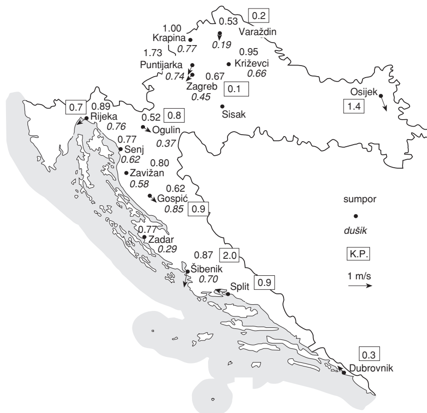
Slika 16. Ukupno mjesečno taloženje sumpora iz sulfata i dušika iz nitrata (kg/ha), prosječna brzina i smjer strujanja, te koeficijent provjetranja (K.P.) u Hrvatskoj za KOLOVOZ 1996. godine
